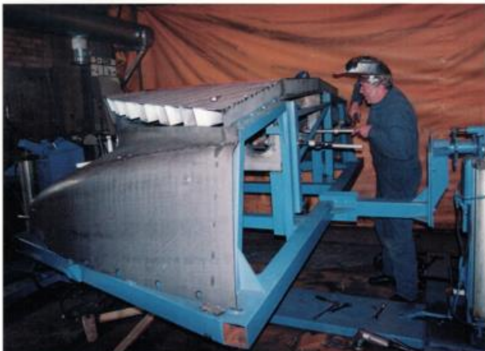
Det är inte bara fronthusarna i plast som tillverkas på KkrV. Nu är också plåt och svets på tåget och tillverkar bl a banröjare till plogen på X 2000-tågen. En av dem som arbetar med detta är Jan Nilsson.
